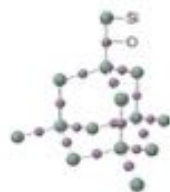
○図24 二酸化ケイ素の構造の例 湿度や圧力によりいくつかの異なる構造をとる。
